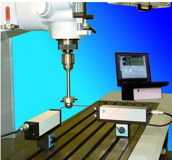
Fif 4 Misura dinamica di eccentricità mandrino
